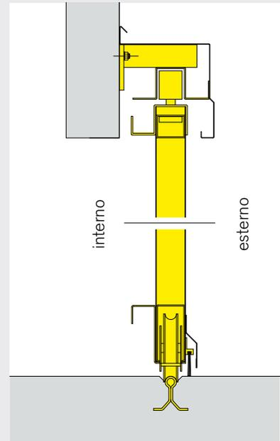
Il movimento del portone è affidato a delle robuste ruote in acciaio zincato, che scorrono perfettamente su una apposita guida annegata nel pavimento. Superiormente il portone è guidato da rulli in nylon che scorrono all'interno di una guida fissata al fabbricato
