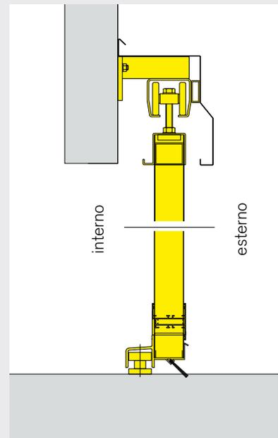
Nei casi in cui non siano previste guida a terra, è possibile ricorrere ad uno scorrevole "appeso". Il movimento del portone e il suo stesso peso, sono quindi sostenuti da carrelli, che scorrono in una guida superiore portante, saldamente fissata al fabbricato mentre a terra rimane solamente il rullo pilota.
